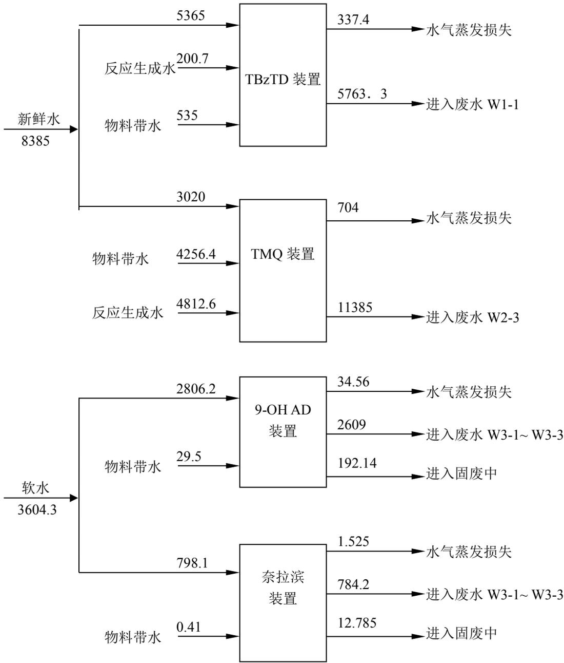
图 3-5 本项目生产工艺用排水平衡图 (单位: t/a)
